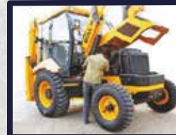
Capó de apertura frontal para mayor accesibilidad
